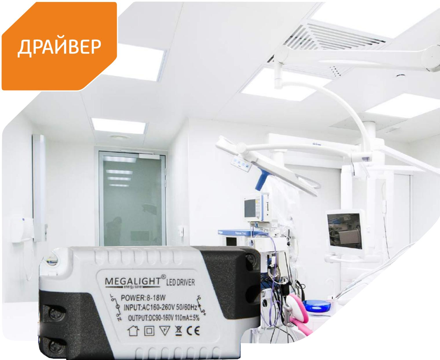
Современные светодиодные светильники требуют использования специальных LED драйверов так-как не могут быть просто включены в сеть питания. Драйвер или как его еще называют блок питания для светодиодов - это устройство на вход которого подается переменный ток из обычной сети (220 Вольт), а на выходе получается постоянный стабилизированный ток или постоянное стабилизированное напряжение.
